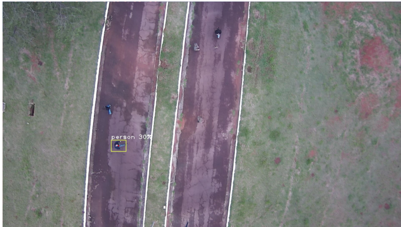
Figura 2.19 - Desempenho Rede YOLO v4 Tiny em imagem captada a 25 metros de altura
