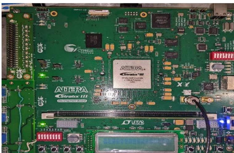
*Figura 4. Imagem do “hardware” do correlacionador do BDA, com a caixa aberta, em teste de bancada.*
