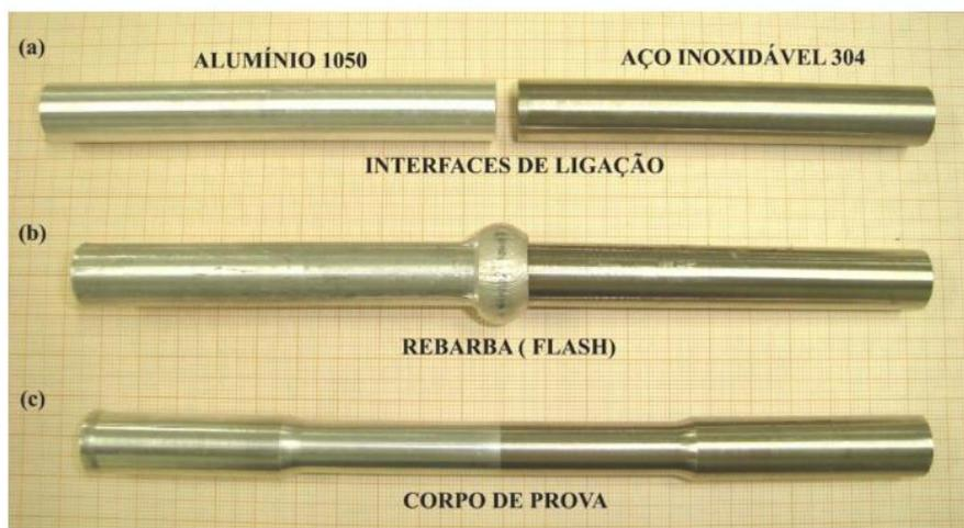
(a) Interfaces de ligação dos pinos; (b) rebarba (*flash*) e (c) corpo de prova para ensaio de tração pós soldagem.
