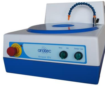
Figura A.5 – Politriz rotativa, marca Arotec, modelo Aropol 2V.
