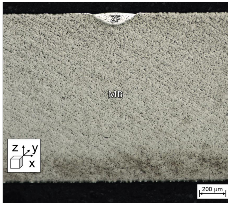
Figura 4.25 – Macrografia da seção transversal do cordão de solda de nióbio obtido a 5 J/mm.
