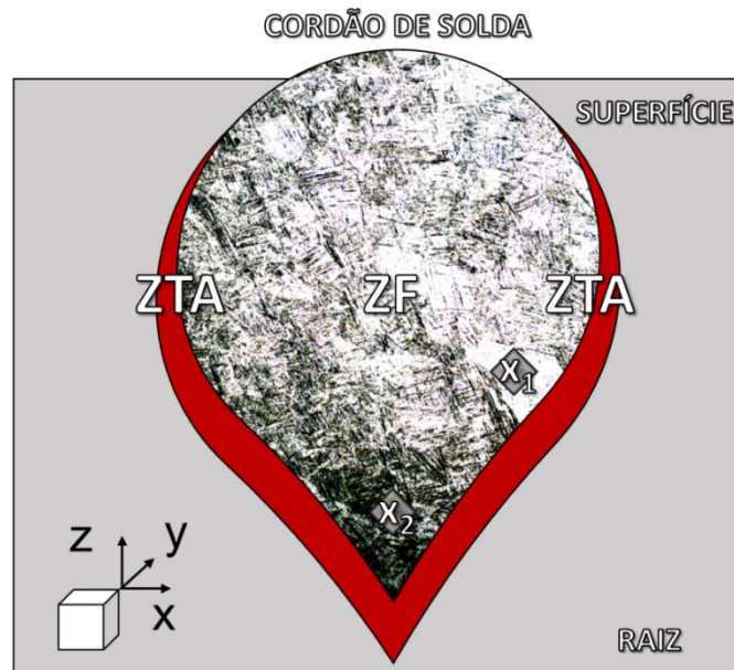
Figura 3.11 – Metodologia empregada na avaliação dos níveis de dureza dos cordões de solda da liga Ti-6Al-4V em regiões com segregações de fases \alpha' e/ou \beta retida.
