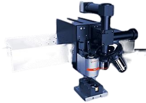
Figura A. 9 – Nanoindentador para medição de dureza instrumentada, marca Anton Paar, modelo NHT 2 .
