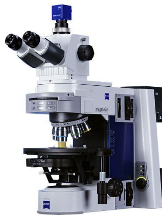
Figura A.6 – Microscópio óptico digital, marca Zeiss, modelo Axio Imager.A2M.
