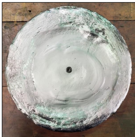
Figura 3.1 – Nióbio metálico, grau comercial (tipo 2), cedido pela CBMM.
