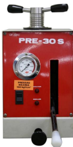
Figura A.4 – Prensa embutidora a quente, marca Arotec, modelo Pre-30 S.
