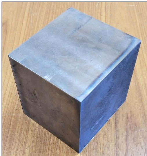
Figura 3.2 – Liga de titânio Ti-6Al-4V, grau 5, cedido pelo IEAv.
