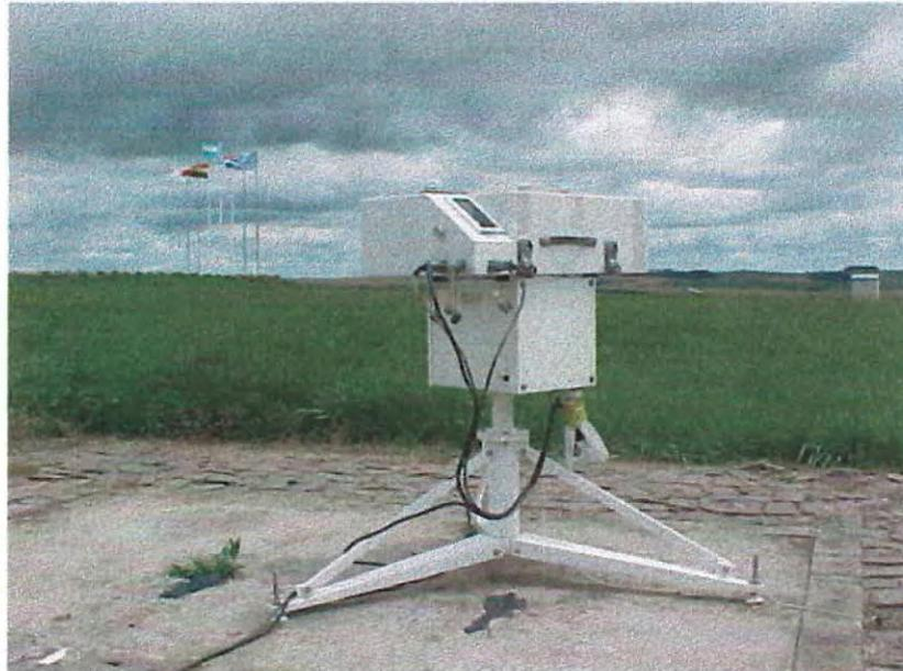
**Figura 35:** Espectrofotômetro Brewer MKII número 056, instalado no OES.
