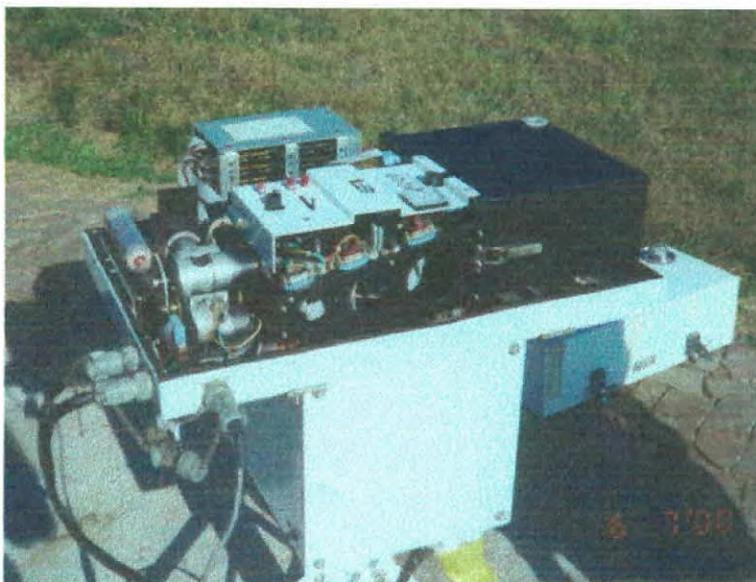
**Figura 41:** Brewer 056 sem a tampa superior. A caixa preta à direita, no interior do aparelho, abriga o sistema ótico do mesmo.
