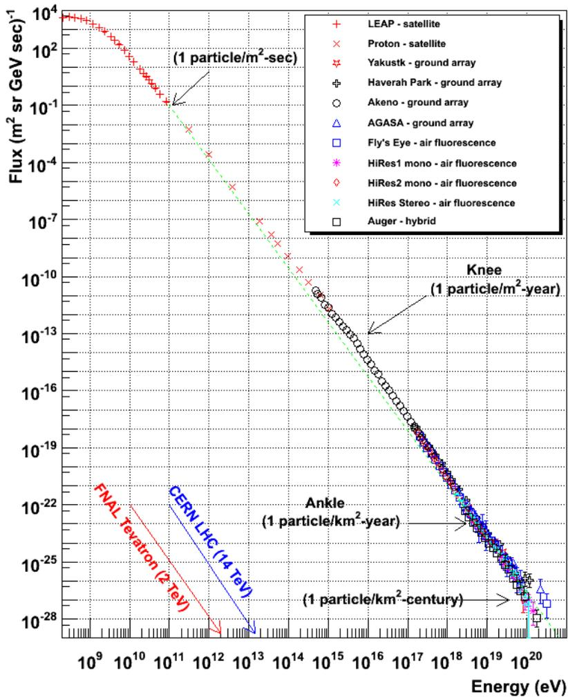
Figura 2.1 - Espectro de energia dos componentes nucleares dos raios cósmicos primários.
