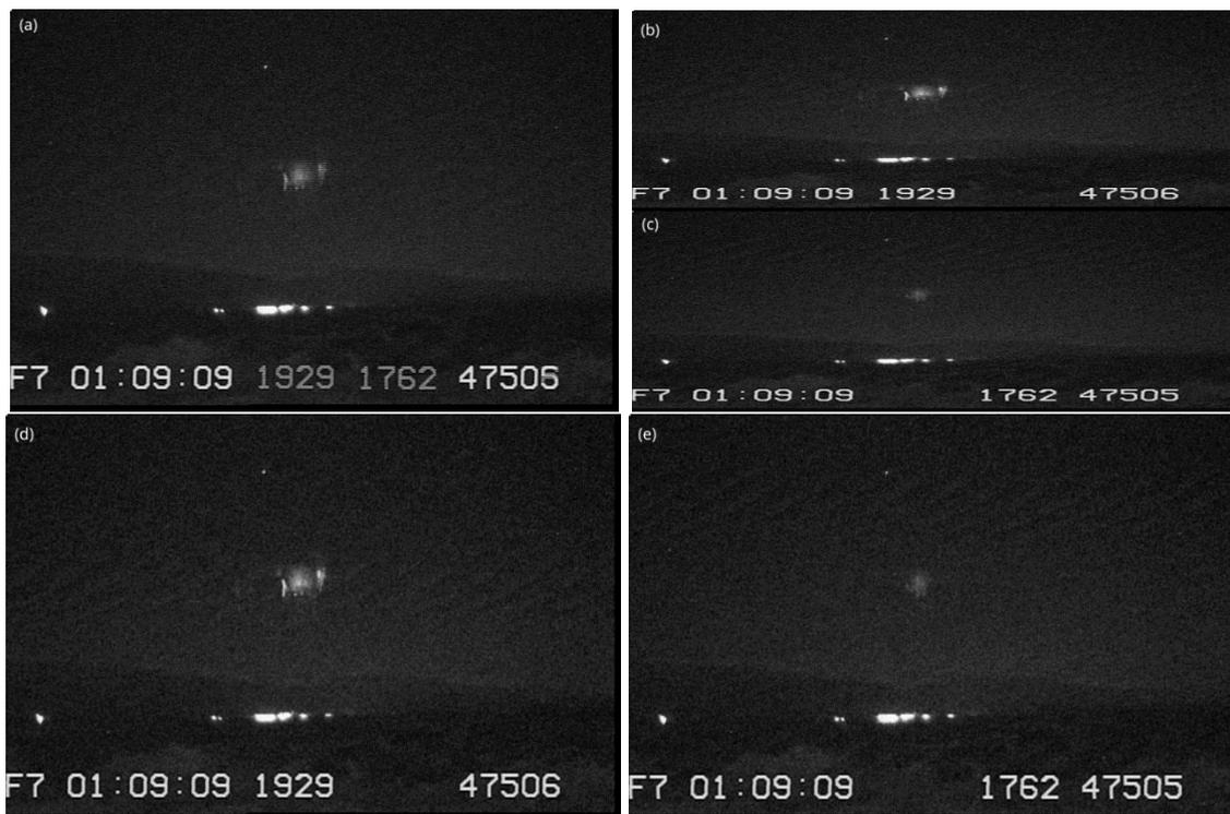
Figura 8.2 - Processo de desentrelaçamento e redimensionamento em MATLAB do quadro (a) do vídeo relativo à tempestade gravada em câmera Wide em Anillaco na noite 08-09/11/2019.
