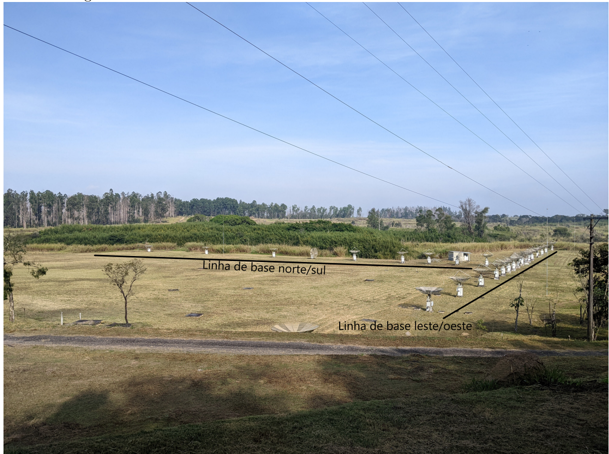
Figura 3.3 - Vista a nível do solo in situ das linhas de base do BDA
