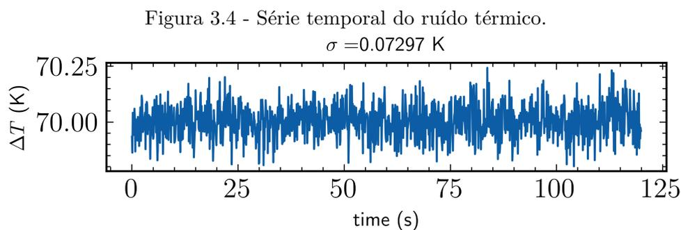
É observado que a média gaussiana será a própria temperatura do sistema, 70 K. O desvio  $\sigma$  padrão foi de 0.07243, obtida pela Equação do radiômetro 3.1.
