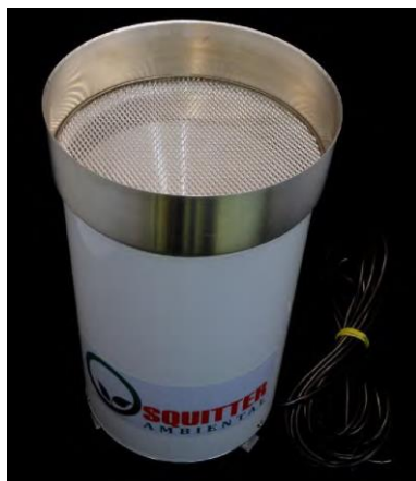
Figura 3.6 - Modelo do pluviômetro utilizado na estação meteorológica.
