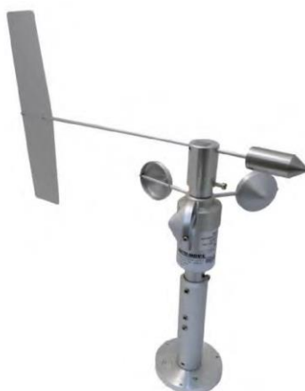
Figura 3.4 - Modelo do anemômetro utilizado na estação meteorológica.
