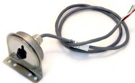
Figura 3.5 - Modelo do barômetro utilizado na estação meteorológica.
