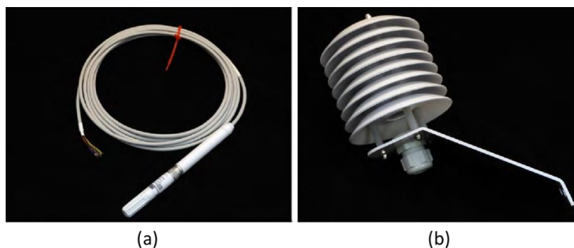
Figura 3.8 - Modelos de (a) Termo-higrômetro e (b) abrigo da estação meteorológica.
