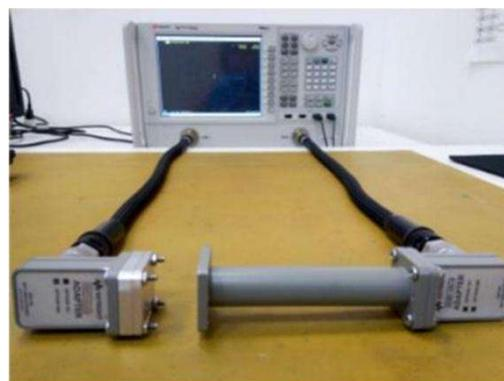
Fig. 1. Foto do equipamento VNA.
